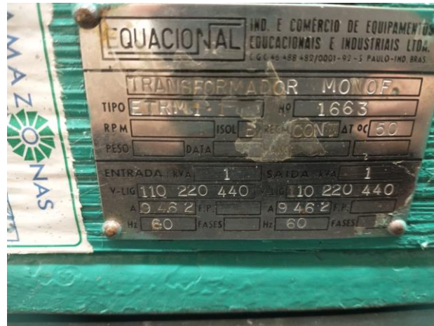
Figura 1: Dados de placa do transformador utilizado.
